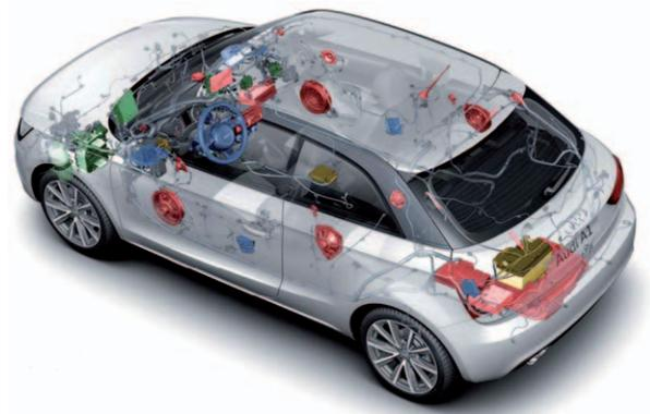
Systemarchitektur der Bordelektronik im Audi e-tron. Die Komponenten des Bordnetzes, die im Projekt betrachtet werden, sind farblich markiert. (Audi AG)
