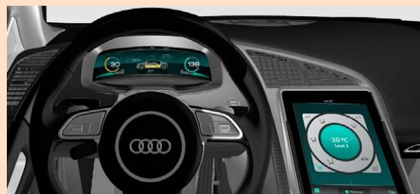
Im Cockpit ist ein iPad (rechts) als zentrales Bedieninstrument eingebaut. (Audi AG)
