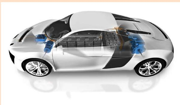
Im Projekt e performance erforshtes Antriebskonzept mit Synchronmaschine auf der Vorderachse, Doppelmotor auf der Hinterachse und der Batterie in der Mitte (Audi AG)
