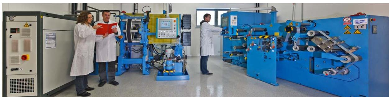
Zu sehen ist der Kalender, ein System aus mehreren Walzen, und die Rollenschneidemaschine für die Elektrodenherstellung aus der Forschungsproduktionslinie in Ulm. (ZSW/M. Duckek)
