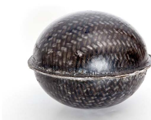
Nach dem TwinOSheet-Verfahren hergestellter Probekörper (bielomatik Leuze GmbH + Co. KG)
