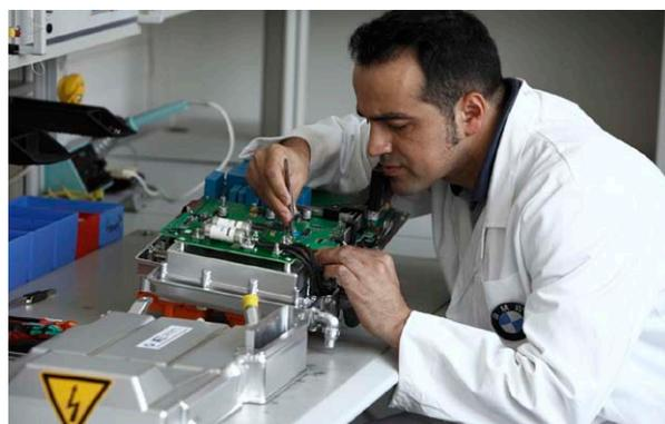
Prüfprozess bei Leistungselektronik-Bauteilen (BMW AG)
