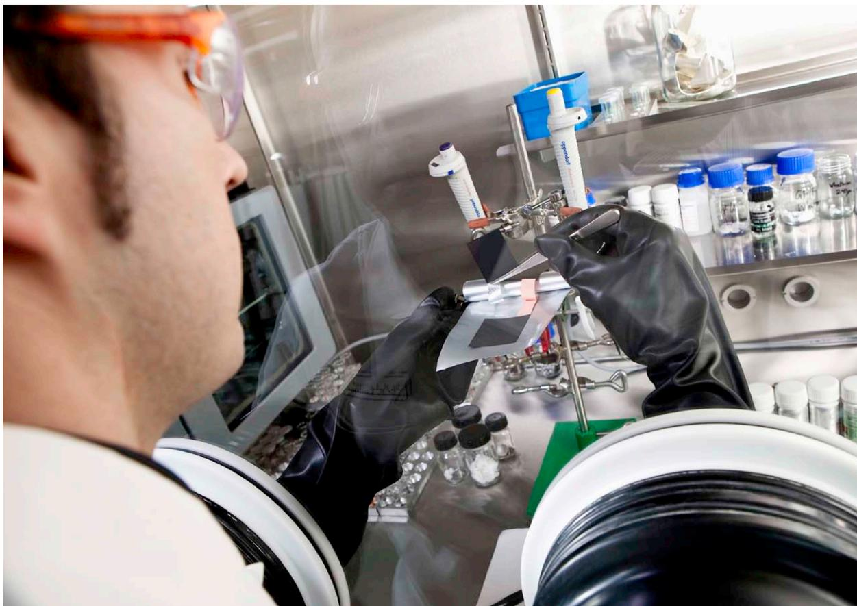
Ein Chemielaborant baut in einem Handschuhkasten (Glove-box) eine Lithium-Ionen-Testbatterie zusammen. Mit ihr werden verschiedene neuartige Kathodenmaterialien untersucht. (BASF)
